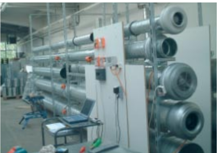
Alle Volumenstromregler werden auf der bei G & P Air Systems installierten Messstrecke kalibriert und geeicht sowie mit kundenspezifischen Parametern programmiert
